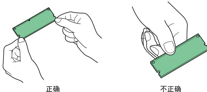
在处理内存模块之前，您需触摸水管（水龙头）或其他较大的金属物体释放身体内的静电以保护电子元件。或者，如果条件允许，应在安装内存模块时穿戴防静电手腕带。
