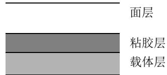
如图所示, 标签纸含有三层。粘胶层内含有的物质容易受机器内施加的力的影响。使用标签纸之前, 载体层一直承接着面层。标签纸的这种构造可能会导致很多故障。
