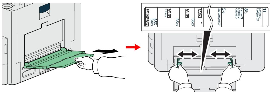
装入尺寸为 A3 至 B4 以及 Ledger 至 Legal 的纸张时，请拉出手送纸盘的支撑托盘部。
