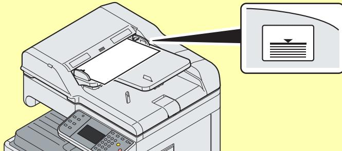
请确认原稿宽度导板是否与原稿完全吻合。如果两者之间存在间隙，请重新调节原稿宽度导板。两者之间的间隙可能会造成原稿卡纸。
